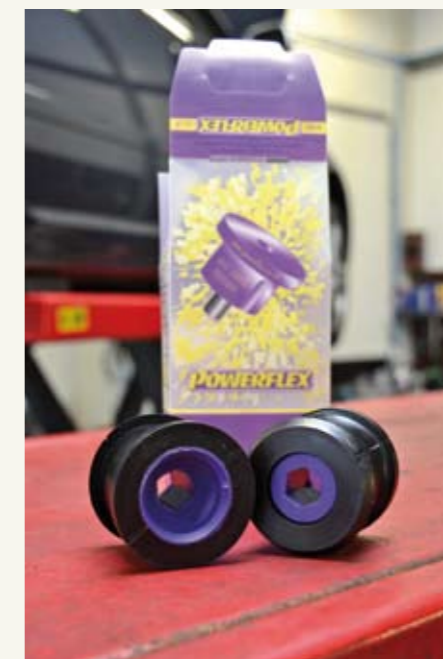
Het ophangrubber rechtsvoor vertoont speling. Aan beide kanten worden ze vervangen door Powerflex rubbers.
